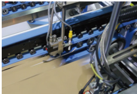
自動噴膠系統 Auto. Glue Injection System
