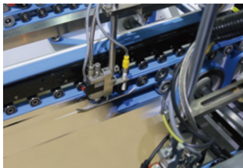
自動噴膠系統 Auto. Glue Injection System
