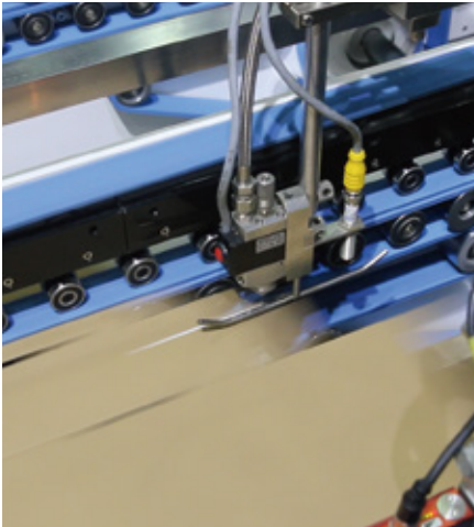
自動噴膠系統 Auto. Glue Injection System
