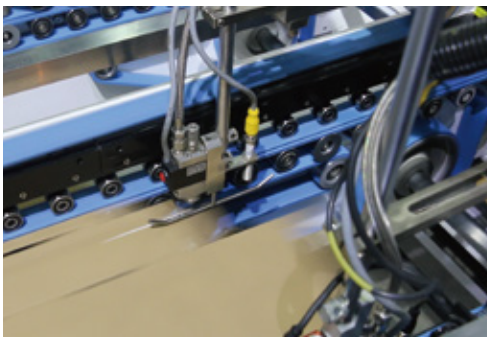
自動噴膠系統 Auto. Glue Injection System
