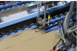
自動噴膠系統 Auto. Glue Injection System
