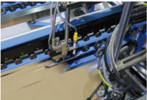
自動噴膠系統 Auto. Glue Injection System
