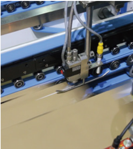
自動噴膠系統 Auto. Glue Injection System
