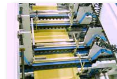
壓線輪裝置 Creasing Wheel Device 紙張經過導正推齊後能準確壓線，減少魚尾公差。
